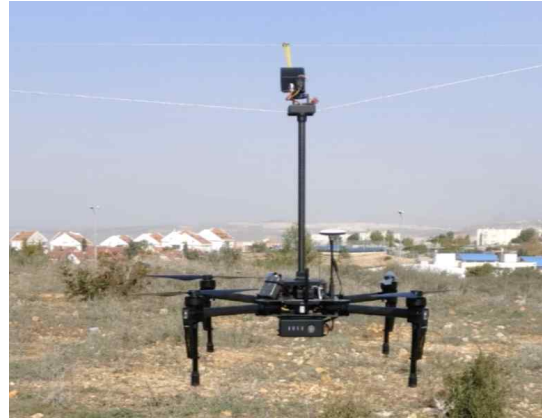
그림 8. 온보드 충전형 드론의 충전 시연 Fig. 8. Charging Demonstration of Onboard Charging Drones(source: Ben-Moshe B, 2021, p11)
