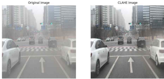
그림 2. 원본 이미지와 CLAHE 적용 이미지 비교 Fig 2. Comparison between the original image and the CLAHE image
