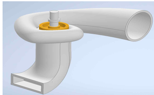
그림 3. M사의 프란시스 터빈 3D 모델 Fig. 3. Power generation systems using fish farm's water
