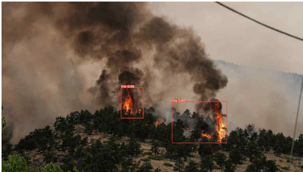
그림 2. YOLOv9-e 모델 화재 감지 예측 결과 Fig. 2. YOLOv9-e model fire detection prediction results
