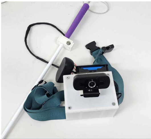
그림 6. 제작된 안전 보행 가이드 Fig 6. Implemented safe walking guide
