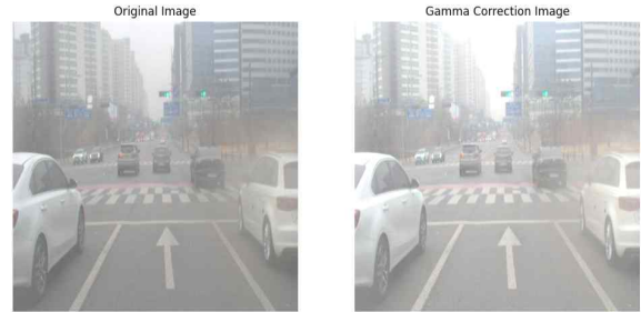
그림 3. 원본 이미지와 감마 보정 적용 이미지 비교 Fig 3. Comparison between the original image and the Gamma Corrected image
