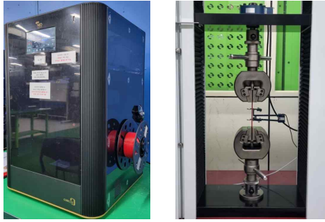
(a) (b) 그림 2. 3D 프린터와 시험 장비 Fig. 2. 3D printer and testing machine (a) 3D printer(Style NEO-A31C) (b) Tensile, shear testing machine(TO-102)
